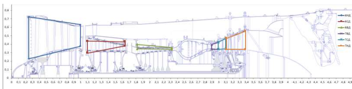
Рисунок 3 – Полученная форма проточной части всех каскадов, наложенная на продольный разрез двигателя
