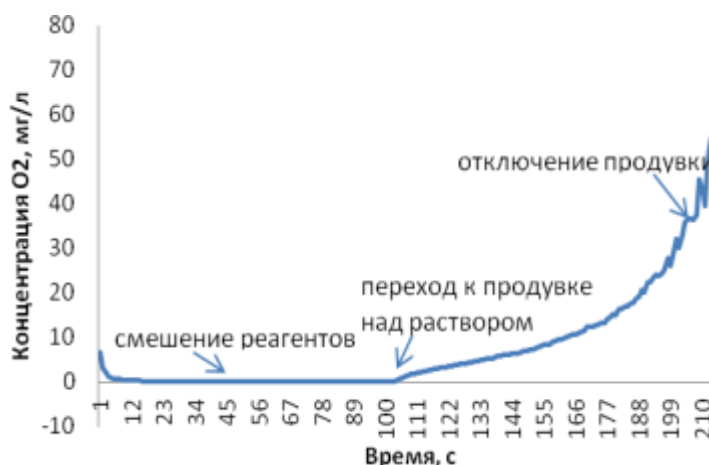
Рисунок 2. Зависимость концентрации кислорода от времени при смешении реагентов: люминол в щелочи и перекись водорода
