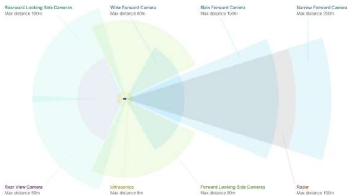
Рисунок 9. Камеры, радары и ультразвуковые сенсоры автомобиля Tesla.
