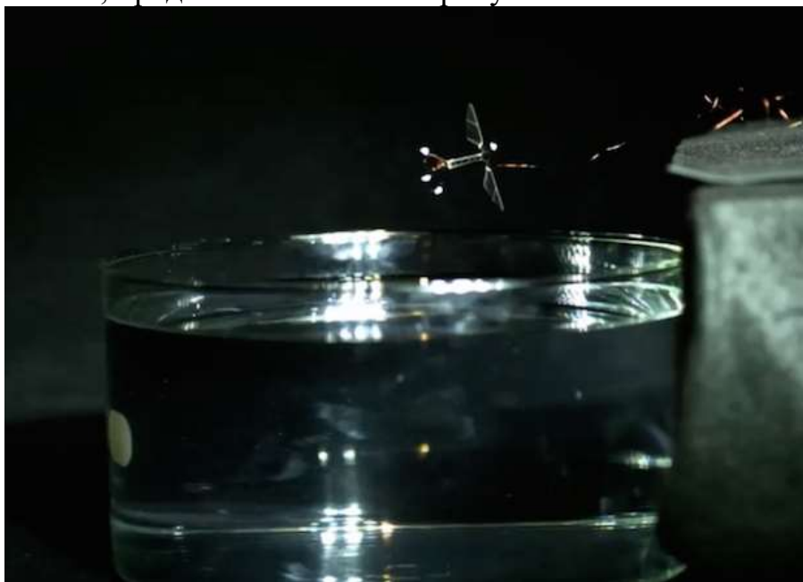
Рисунок 1 – робот-пчела во время испытаний.
