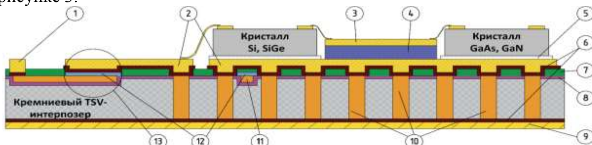
Рис. 3. Схематичная конструкция ППСМ на кремниевой коммутационной плате,
