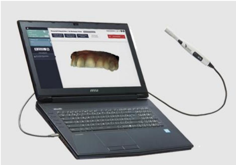
Фото 2. Интраоральный сканер использовался для создания цифровых оттисков зубов.
