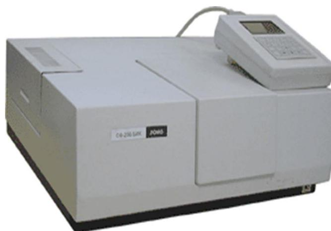
Рисунок 2 – Спектрофотометр СФ-256
