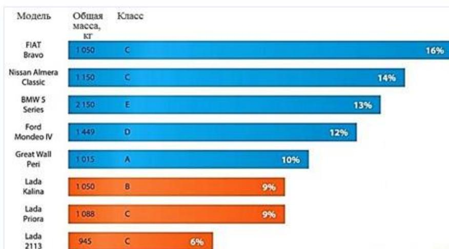
Рисунок 2. Весовое содержание полимеров в различных моделях автомобилей.
