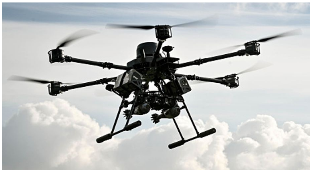
Рисунок 6 – Украинский тяжелый гексакоптер военного назначения «Вампир» с устройством для сброса боеприпасов и двумя минометными минами ( https://www.dailystar.co.uk/news/world-news/ukraines-feared-vampire-drones-compared-32292353 )
