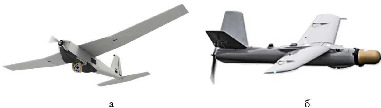
Рисунок 4 – Беспилотники ВСУ самолетного типа СБС: американский разведывательный БЛА RQ-20 PUMA (а) и польский дрон-камикадзе Warmate 2.0 (б)
