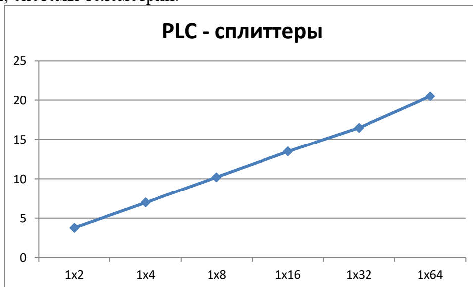
Рисунок 2 - Зависимость затухания от количества ответвлений PLC - сплиттеров
