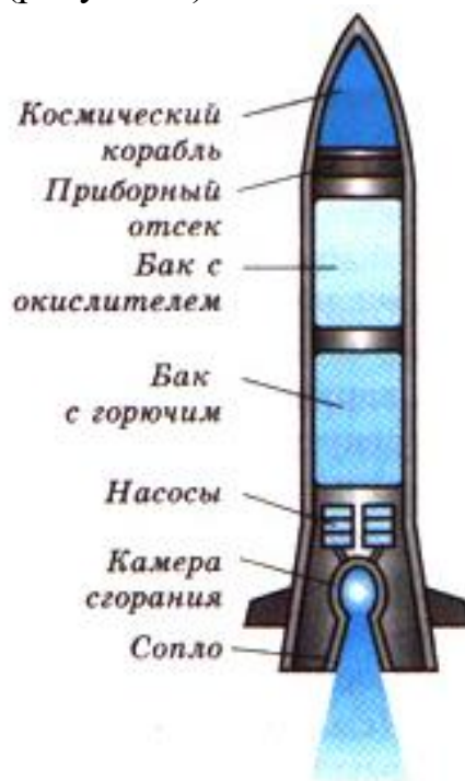
Рисунок 1 – Устройство ракеты-носителя
