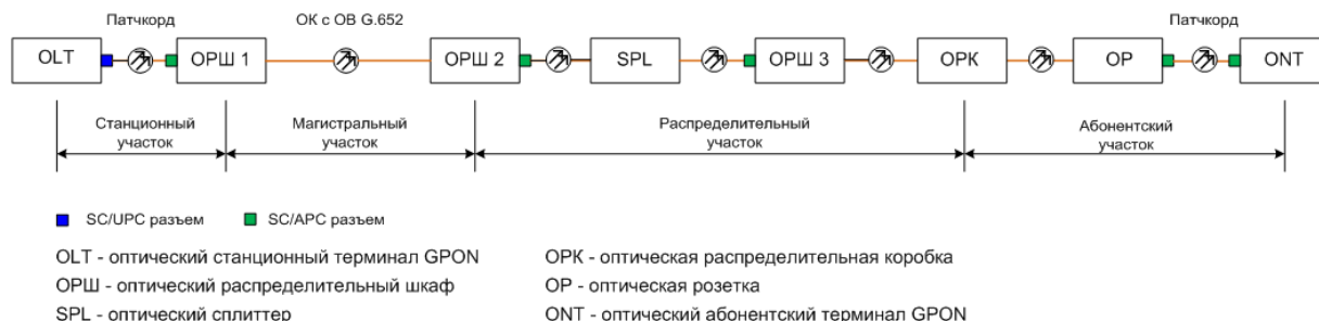
Рисунок 1 - Линейная часть GPON-сети
