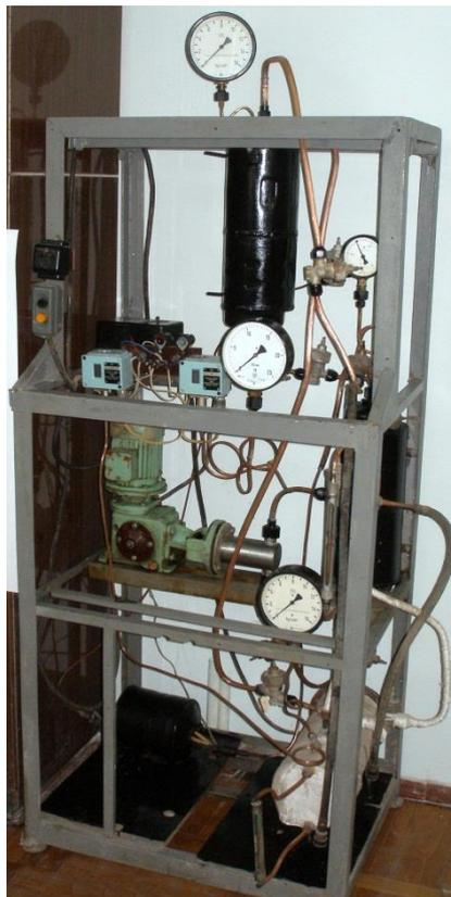
Рисунок 1.5 - . Установка для очистки внутренних полостей агрегатов сплит-систем
