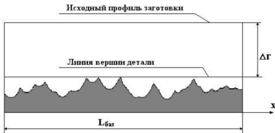
Рисунок 1 – Топография обработанной поверхности.
