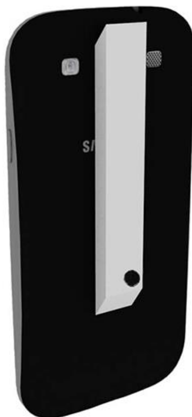
Рис. 3. Мини-спектрометр укрепленный на смартфоне
