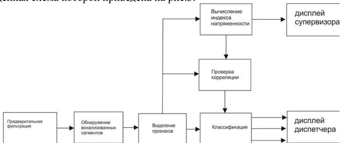
Рисунок 3. Обобщенная схема 2-х уровневой системы мониторинга
