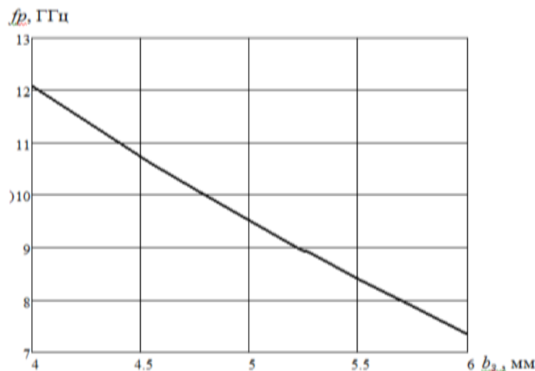
Рис. 3. Зависимость резонансной частоты резонатора на запредельном волноводе от глубины погружения настроенного винта b_3 (расчет на ЭВМ).
