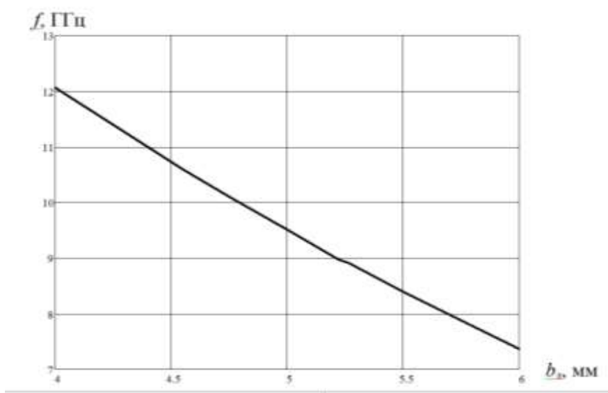
Рис.6. Зависимость резонансной частоты фильтра от глубины погружения винта
