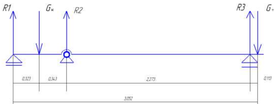
Рисунок 2 – Схема нагружения опор
