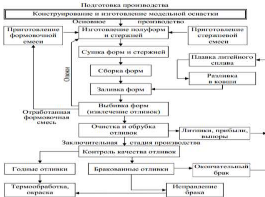
Рис. 1. Технологический процесс производства отливок в опочных формах
