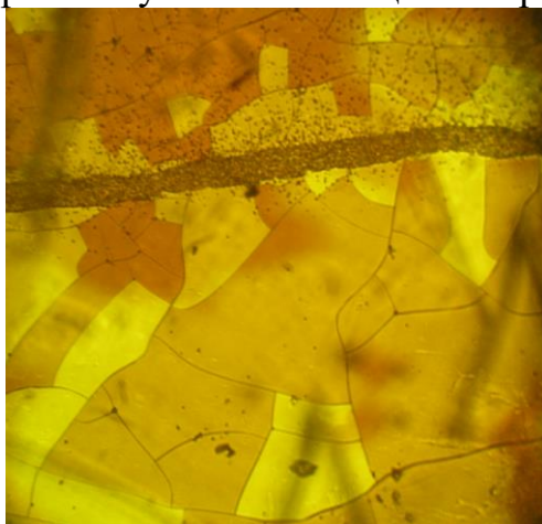
Рис. 5 – Наруженная поверхность феррито – гранаты
