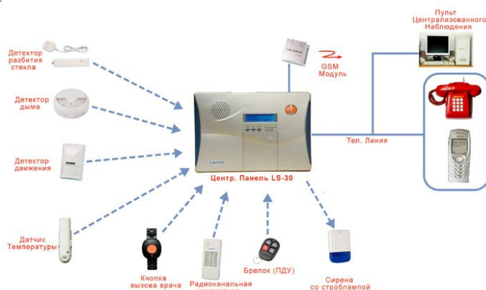
Рис.2 – Система беспроводной GSM охранной сигнализации
