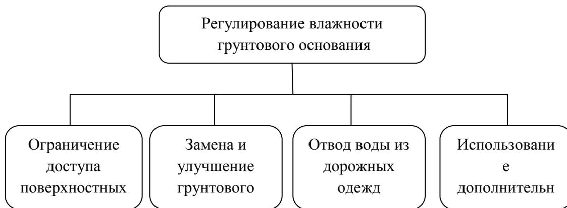
Рисунок 1 – Методы регулирования увлажнения грунтового основания
