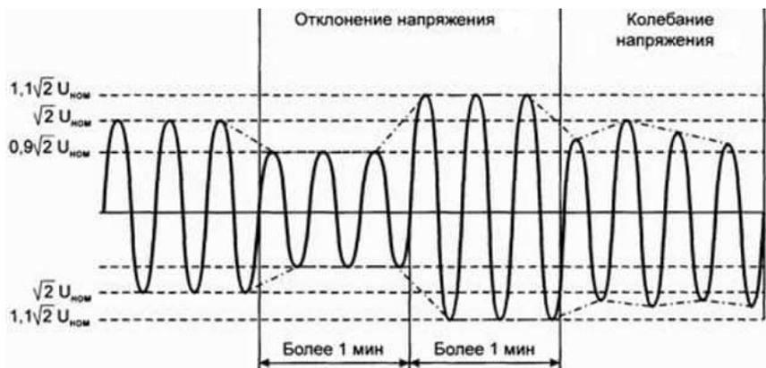
Рис.1. Установившееся отклонение и колебания напряжения.
