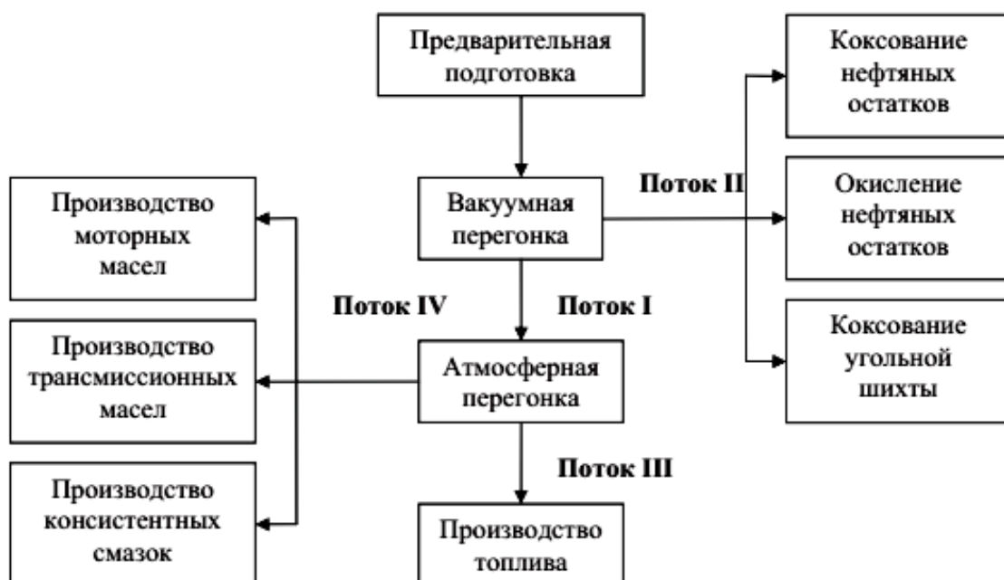
Рис. 2. Схема комплексной переработки отработанных моторных масел
