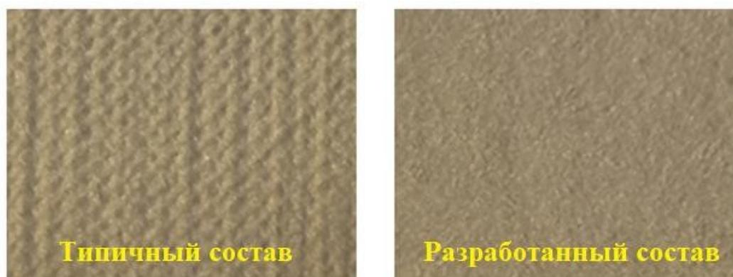
Рисунок 2 – Рельеф поверхности металлизации при использовании пасты с типичным (прототип) и разработанным составом связующего вещества
