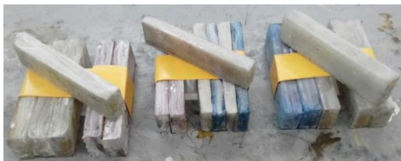
Рисунок 3. Общий вид образцов после шлифования
