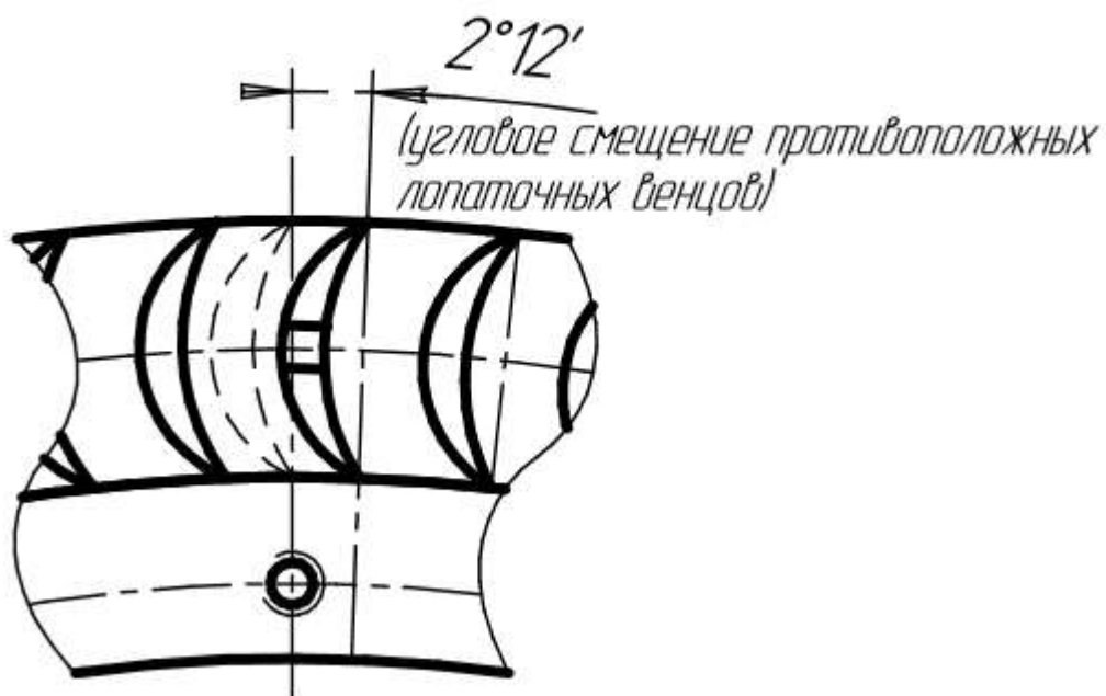
Рис. 7. Колесо с угловым смещением лопаточных венцов.
